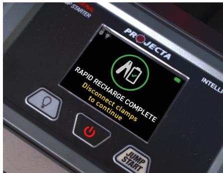
Warten Sie 40 Sekunden, bis der Schnellladevorgang abgeschlossen ist. Nachdem Sie das Gerät ausgeschaltet haben, können Sie die Klemmen abnehmen.
