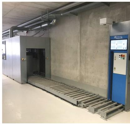
Die Radwäsche läuft mit Be- und Entladen der Räder vollautomatisch ab.
