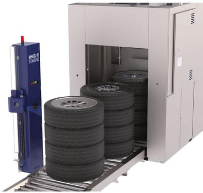
In einem Arbeitsgang misst Wheelscan die Profiltiefen von einem Satz Reifen.
