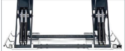
Doppelte hydraulische Absenkerriegelung
