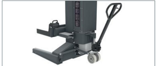
Mit handhydraulischem Fahrwerk variabel positionierbar
